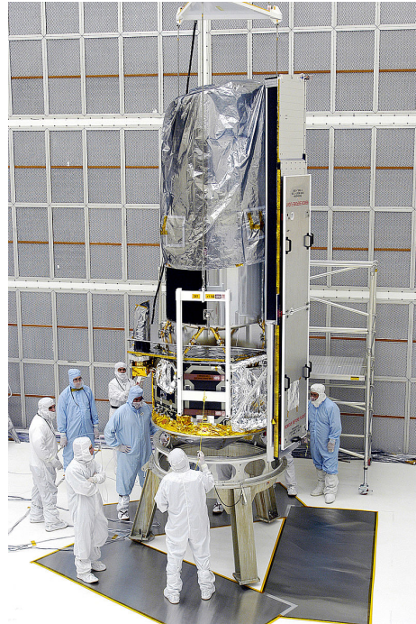
FIGURE 18 – Le Space Infrared Telescope Facility (SIRTF), également connue sous le nom de télescope spatial Spitzer. Notez le soin apporté à la protection contre la poussière. Domaine public
