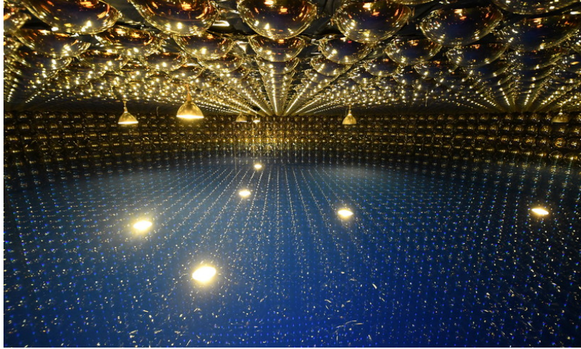
FIGURE 36 – Le détecteur de neutrinos Super-Kamiokande est une vaste cavité construite à 1000 mètres au fond d’une mine de zinc sous le mont Ikeno, près du village de Kamioka au Japon. Image : T2K/Super-Kamiokande
